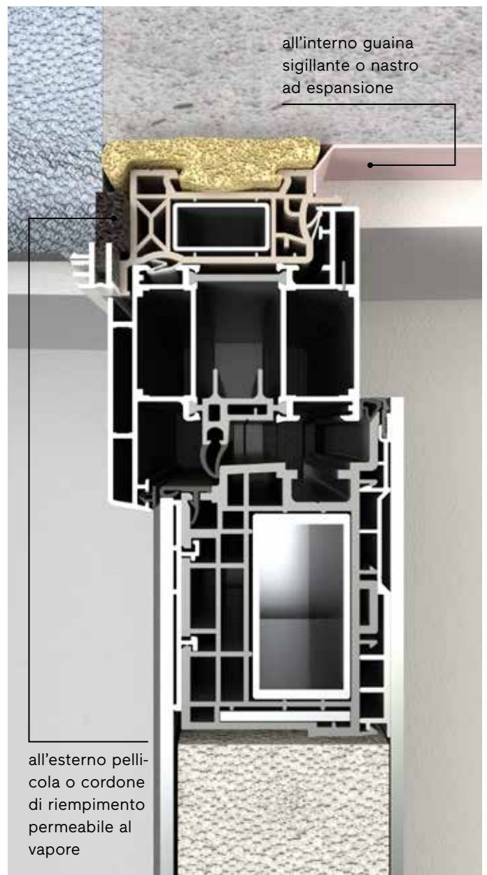
Posa in due fasi con controtelaio
