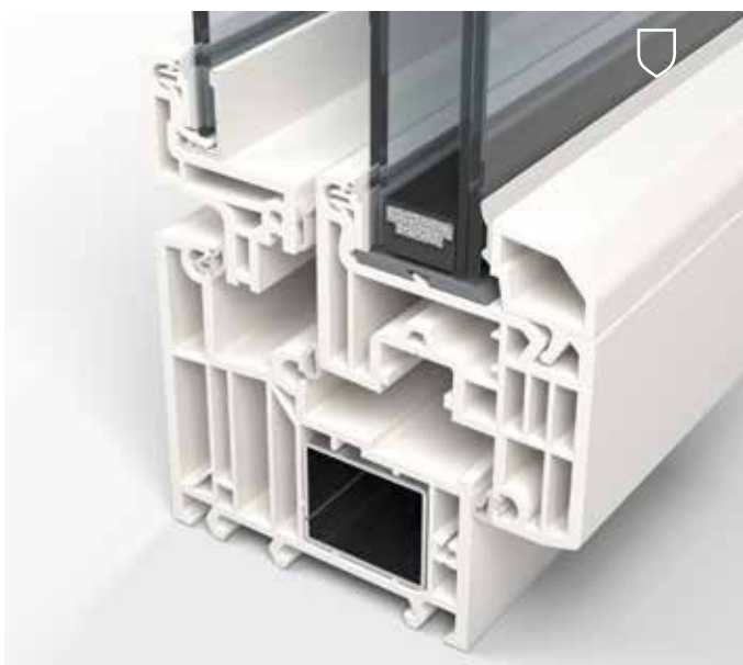
Schnitt durch ein Verbundflügel-Fenster mit drei Scheiben, innere Scheibe Verbundsicherheitsglas Multiprotect
