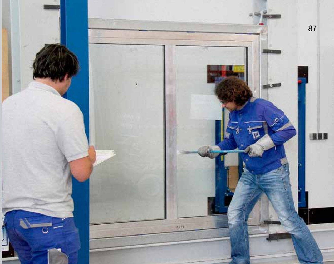
Am Prüfstand untersucht das Institut für Fenstertechnik (ift) Rosenheim die Einbruchsicherheit von Fenstern.
