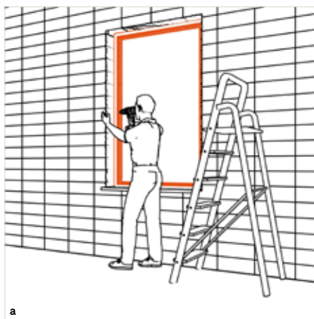
Montiamo il telaio nella muratura nella fase di costruzione al grezzo.
