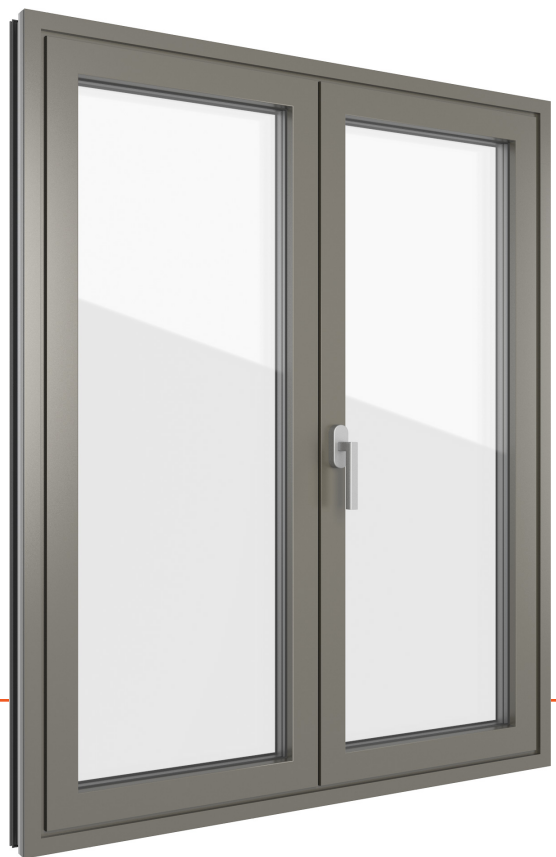
Abbildung in zweiflügliger Ausführung mit glasüberdeckter Mittelpartie Nova und raumseitig flächenbündigem Blendrahmen und Flügel, außen und innen Aluminium Classic 805, Randemaillierungsfarbe Schwarz G01
