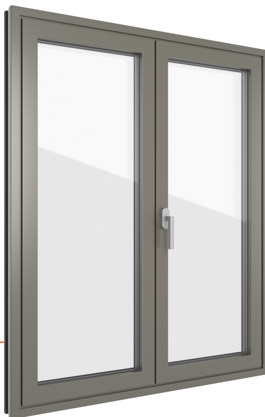
Figura: versão de duas folhas com perfil de batente Nova completamente recoberto por vidro e aro e folha faceados pelo interior, exterior e interior em alumínio Classic 805, com moldura esmaltada a Preto G01
