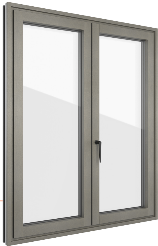
Abbildung in zweiflügliger Ausführung mit raumseitig flächenbündigem Blendrahmen und Flügel, außen Aluminium Classic 805 und innen Holz Quarzgrau 3X04
