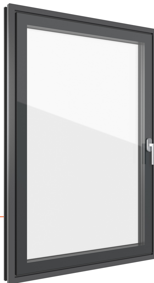
Figura: versão de uma folha com aro e folha faceados pelo interior, exterior e interior em alumínio Sablé 583 Antracite, com moldura esmaltada a Preto G01
