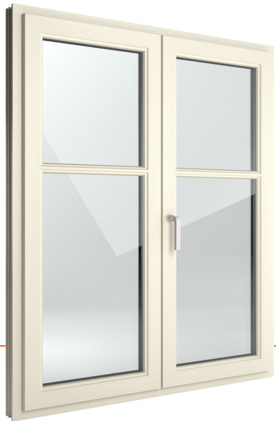
Afbeelding in tweevleugelige uitvoering met glaslat en opgeplakte roede in design Stijl, buiten en binnen kunststof parelwit 07
