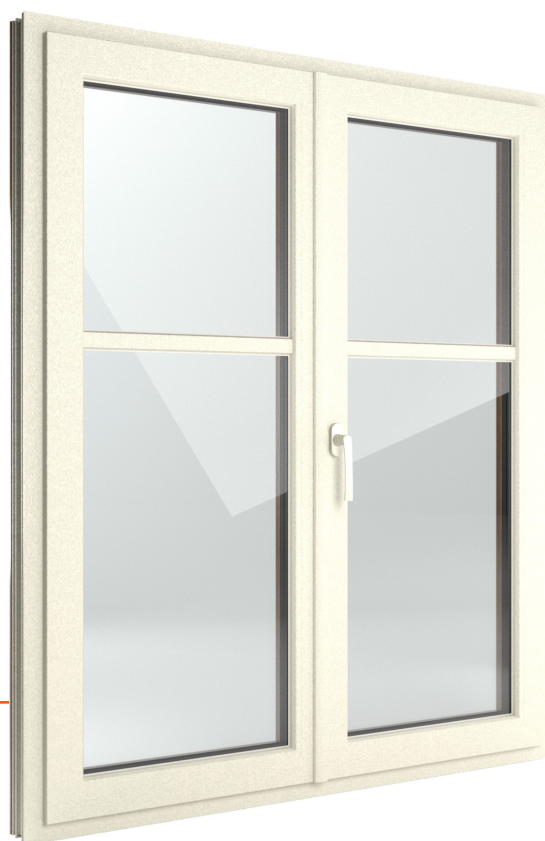
Afbeelding in tweevleugelige uitvoering met glaslat en opgezette roede in design Classic, buiten aluminium castagno L13 en binnen kunststof parelwit 07
