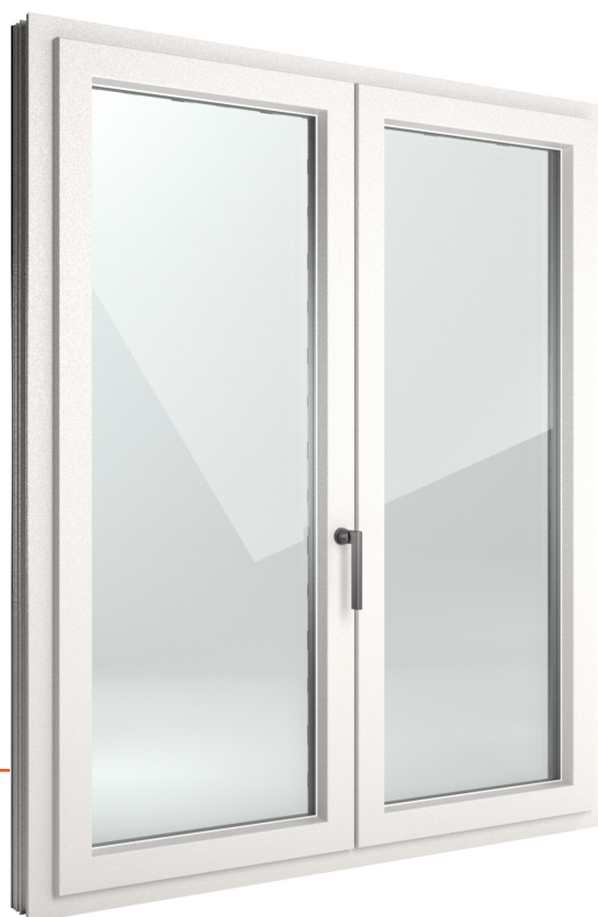
Figura: versão de duas folhas com perfil de batente Nova completamente coberto por vidro, exterior em alumínio Classic 303 e interior em PVC Branco satinado 45, cor do esmaltado perimetral Negro intenso G01
