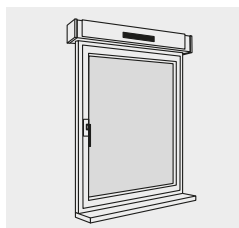
Montagem por cima da janela
