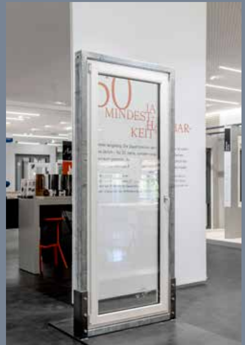
Dauerfunktionstest einer Finstral-Aluminium-Kunststoff-Fenstertür 90 × 230 cm, durchgeführt am Institut für Fenstertechnik (ift) Rosenheim mit 65.000 Zyklen nach der Prüfnorm für Dauerfunktion EN 12400:2002:10; das entspricht mehr als dem Dreifachen der Anforderung der RAL Gütegemeinschaft.
