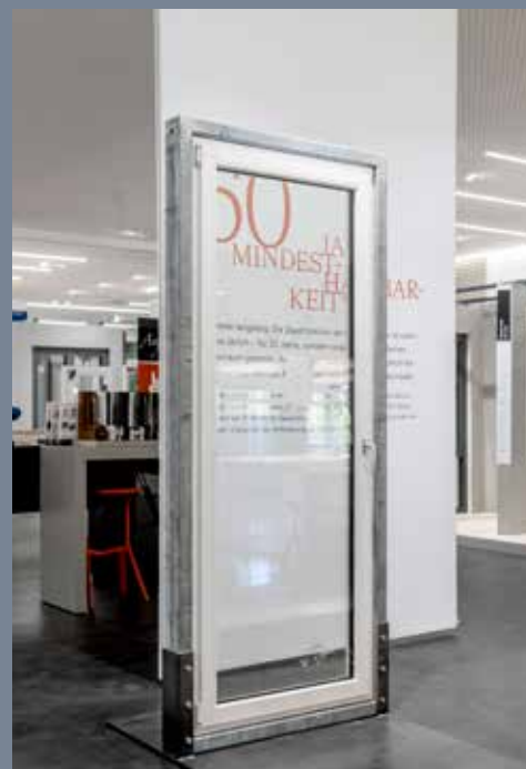
Test de durabilité d'une porte-fenêtre Finstral en aluminium-PVC 90 × 230 cm, réalisé à l'Institut für Fenstertechnik (ift) de Rosenheim avec 65 000 cycles selon la norme d'essai de durabilité mécanique EN 12400:2002-10 ; cela correspond à plus de trois fois l'exigence requise par le label de qualité RAL.
